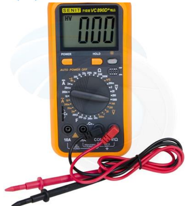
Унимјер мјери једносмјерни напон до 1000V
